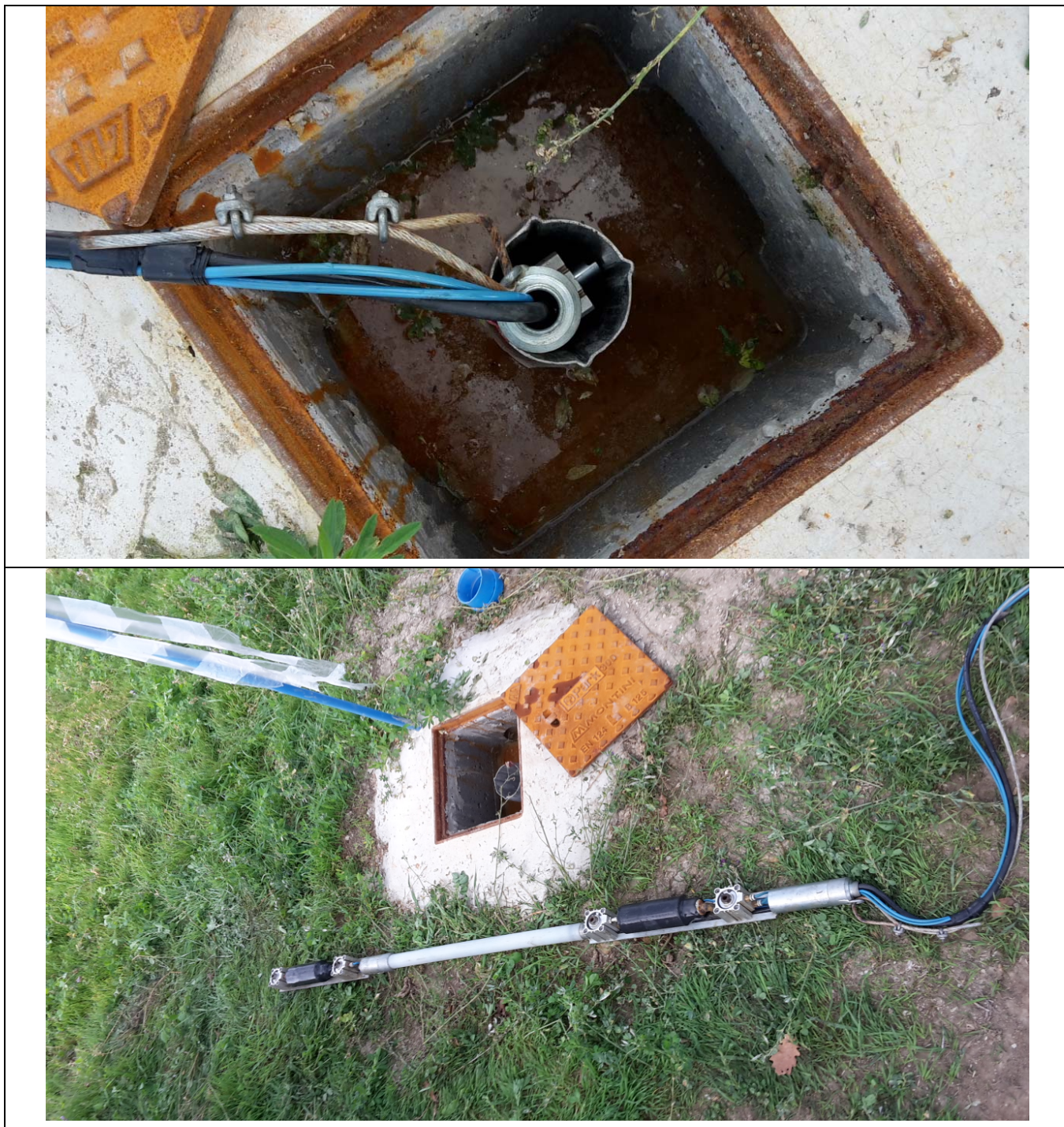
Sistema Down-Hole a doppia terna tridirezionale utilizzato nell'indagine sismica
