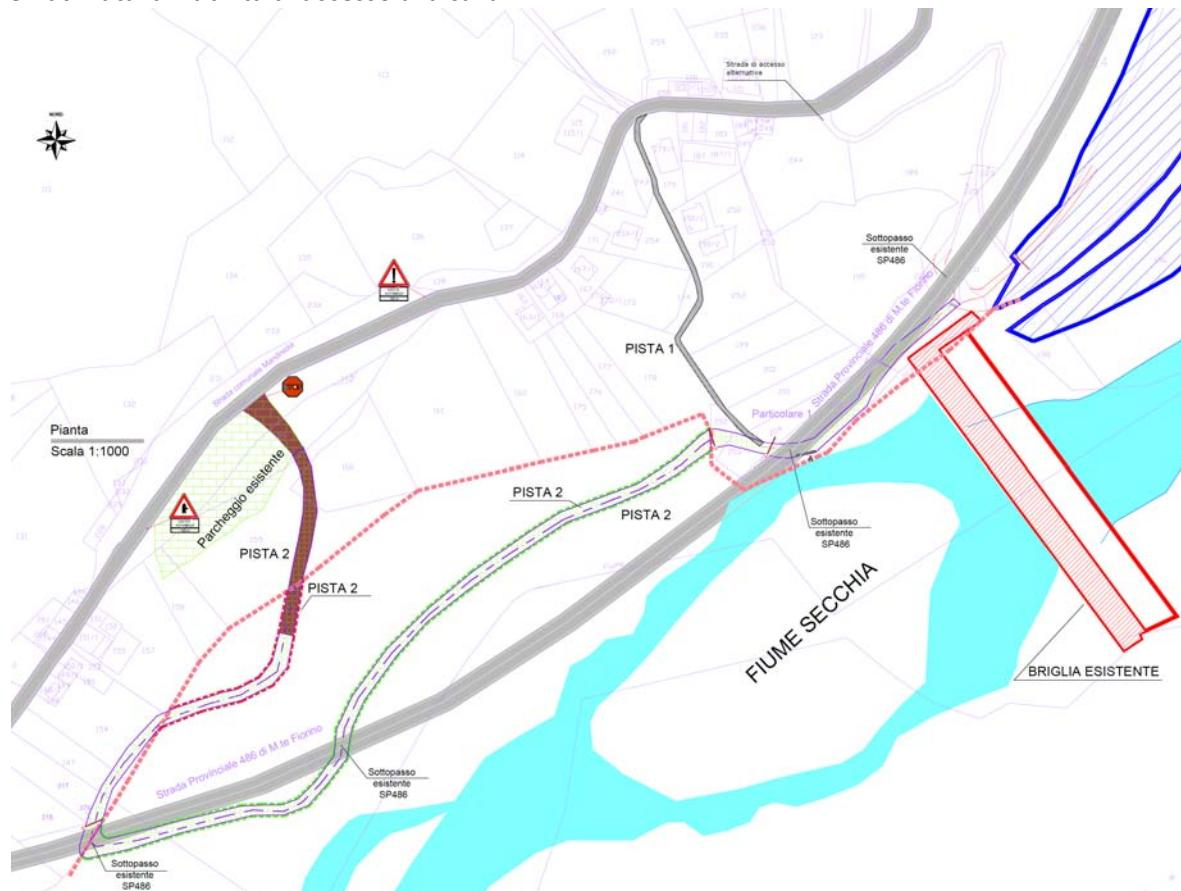
Figura 3.13. Ubicazione delle piste di accesso su base catastale (non in scala).
