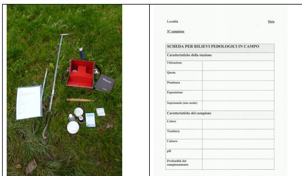
Figura 2.5. Attrezzatura e scheda per i rilievi pedologici in campo.
