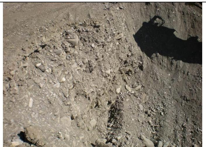
Figura 2.26 Taglio del fronte di scavo per visionare la tipologia del deposito (AES8a), granulometria ed eventuali embricate.
